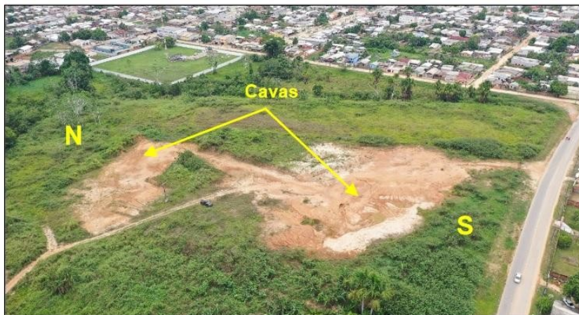
Figura 2 – Visão geral aérea da área examinada destacando as cavas onde houve autuação por lavra irregular (N – Norte, S – Sul).
